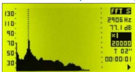
Este módulo de análise de frequências extendido do sonómetro **SC260** incorpora 2 modos de medição: modo análise de frequências extendido de 1/3 de oitava e modo análise de frequências de banda estreita FFT (Fast Fourier Transform).
