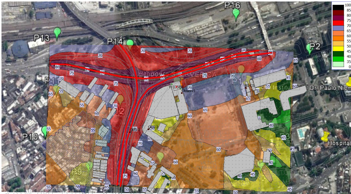
Figura 78 - Resultados da modelagem do Leq.A da situação encontrada sem operação no heliponto, georreferenciada.
